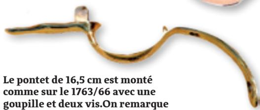
Le pontet de 16,5 cm est monté comme sur le 1763/66 avec une goupille et deux vis. On remarque la position du trou de la goupille qui est assez peu précise, montrant ainsi une impréparation sans un gabarit qui serait nécessaire dans une production de série.
