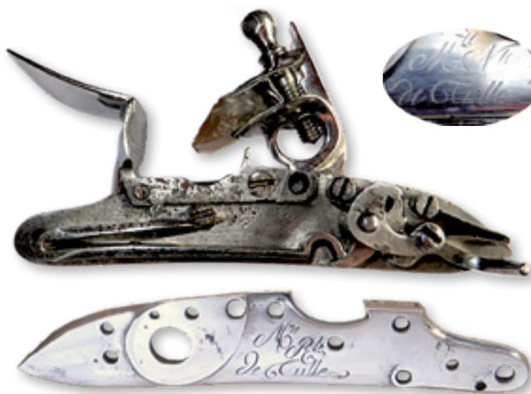
Platine de très belle fabrication du type 1774. Elle est affinée dans sa partie arrière et centrale. Le mécanisme est classique.
