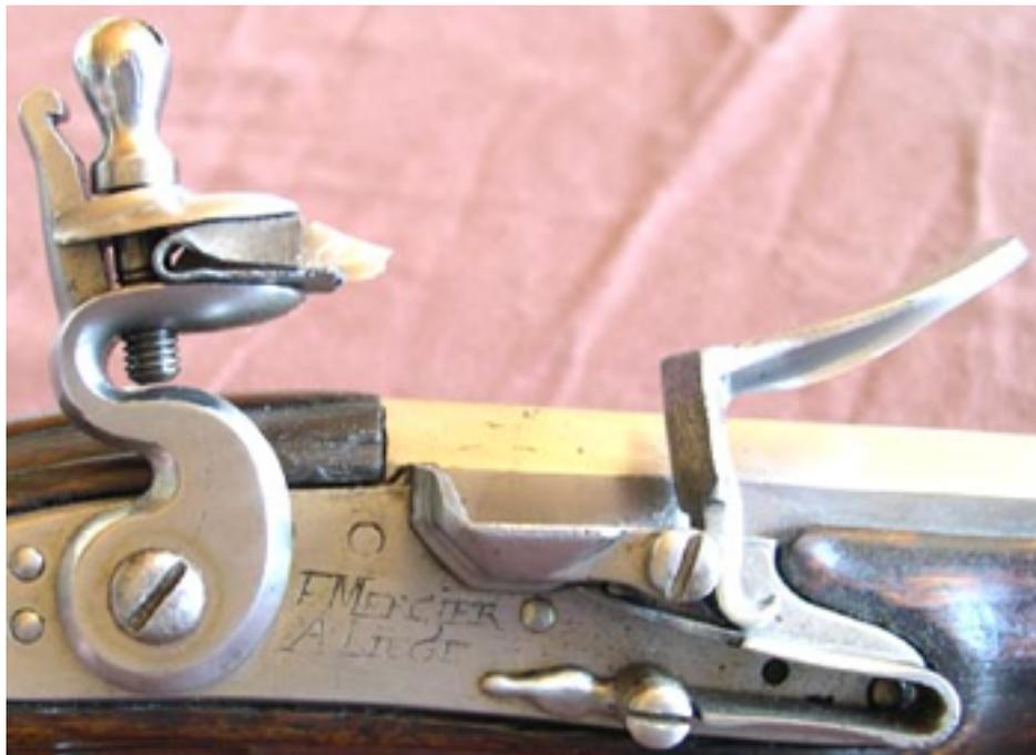
Sur ce pistolet de cavalerie daté de 1749, la bassinet porte une bride qui vient solidement fixer le pivot de la batterie.
