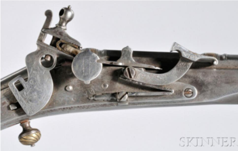
Un couvre bassinnet ultra simple protège la poudre dans le bassinnet . Pour préparer le coup on relève la batterie en position haute . Le chien peut alors venir frapper la batterie avec sa pierre de silex. L'escamotage de la batterie pouvait servir de sécurité, le coup ne pouvant pas déclencher d'étincelles .
