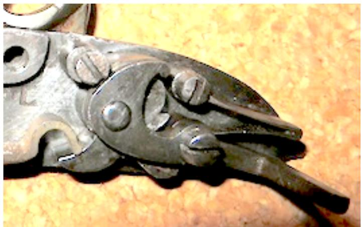
Une autre caractéristique de l'évolution des platines se trouve dans la bride de bassinet. Jusque vers 1730-40 la batterie était fixée à la platine par une simple vis. Ce montage était assez fragile et prenait facilement du jeu.
