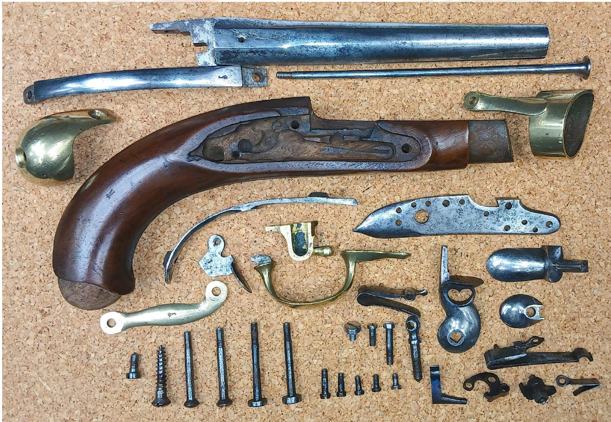
Eclaté montrant l'ensemble des 36 Pièces de ce pistolet An13 de la Manufacture de St Etienne produit en 1808
