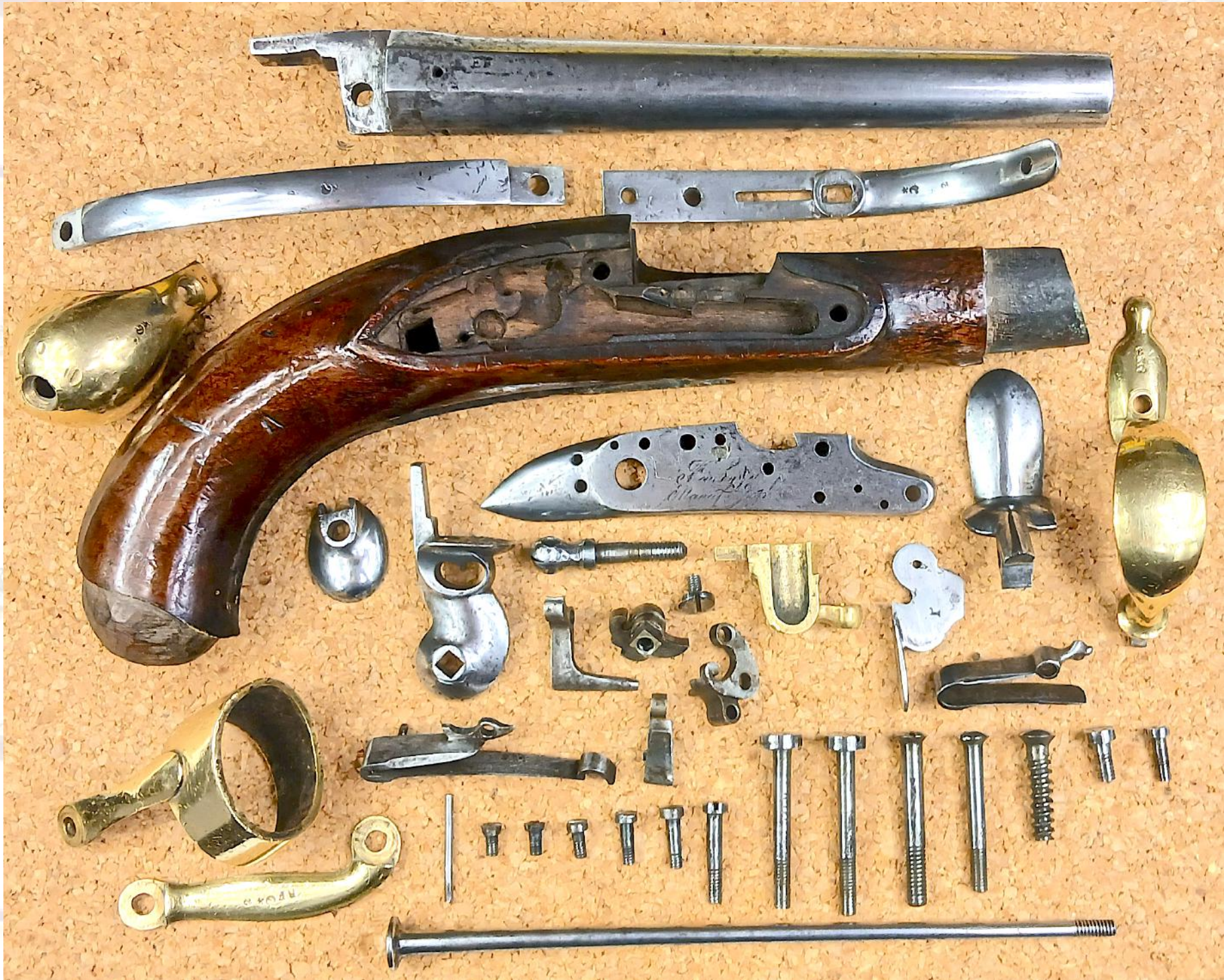
Eclaté complet de ce pistolet An13 dont toutes les pièces sont d'origine
