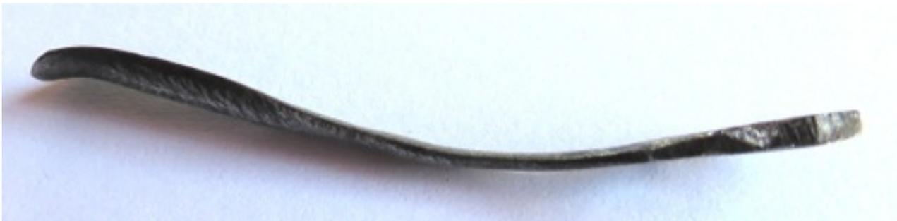
Epaisseur au plus fort 2mm forgé de plus en plus fin . Extrémité mise en forme à chaud
